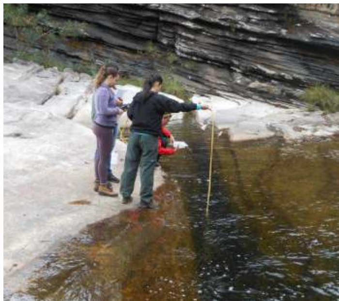
Profª Giovanna Calazans e os alunos Flávia Dark Nascimento, Ademerson Cleiton Marciano e Gilcilaine da Silva Perdigão utilizando sonda multiparâmetro para monitoramento da qualidade da água
